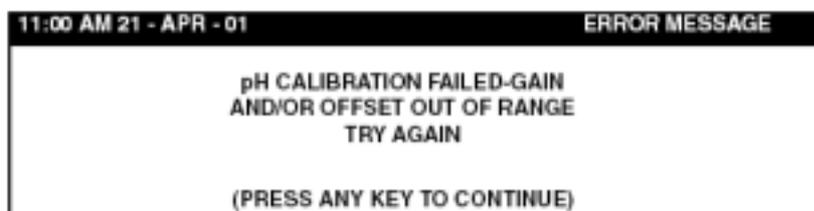
在按了任意一个键后,将会试图读取第二个缓冲溶液的 pH 值。如果这也失败的话,意味着您所使用的是—支坏的 pH 值探头,或者是错误的缓冲溶液。请换用一套新的缓冲溶液,如果不行的话再换用另外一支 pH 值探头。
