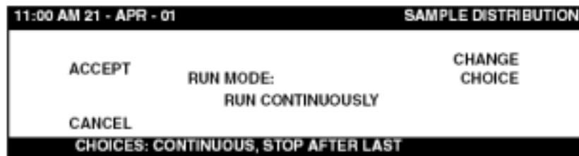
6-B. 按“ACCEPT(接受)”软键继续，转入到液体传感器 (Liquid Sensor) 设置。
