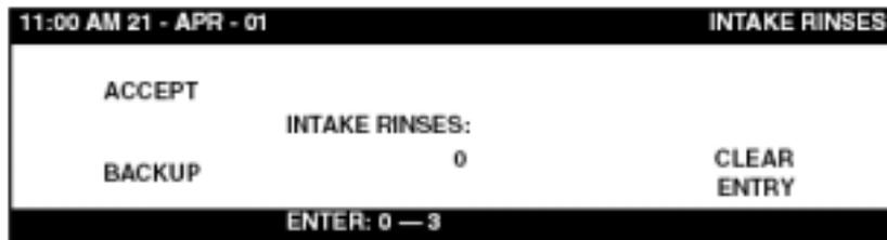
最多可以为每个采样循环设置三次淋洗。在采样循环完成第一次吹脱后，抽取样品流体直到其到达液体传感器。在液体入瓶之前，泵先停止并吹脱管线。在实际的采样发生之前这可以重复三次，在采样循环的最后阶段管线也将进行吹脱。
