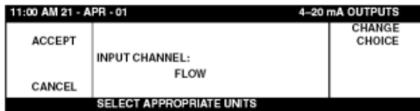
6. 分配一个通道值为 4 mA 电流值。这个值典型地为 0，然而任意值都可以设置。输入需要用来在输出端产生 4 mA 电流的输入端的值。
