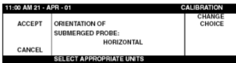
3. 将传感器拉出水面，以与您在前面步骤所选择的相同的方向置于空气中（水平或者垂直）（如图 19）。然后按“**ACCEPT**（接受）”软键继续。
