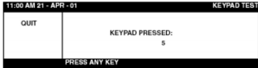
按前面板上的任意键（除了左上方的键，这将引起该键的标签显示在显示屏的中心）。
