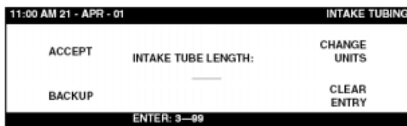
2-A .用数字键盘输入与采样器相连的泵管的长度。长度值从100~3000厘米(3~99英尺)是合法值。用“CHANGE UNITS (更改单位)”软键来更改测定单位。
