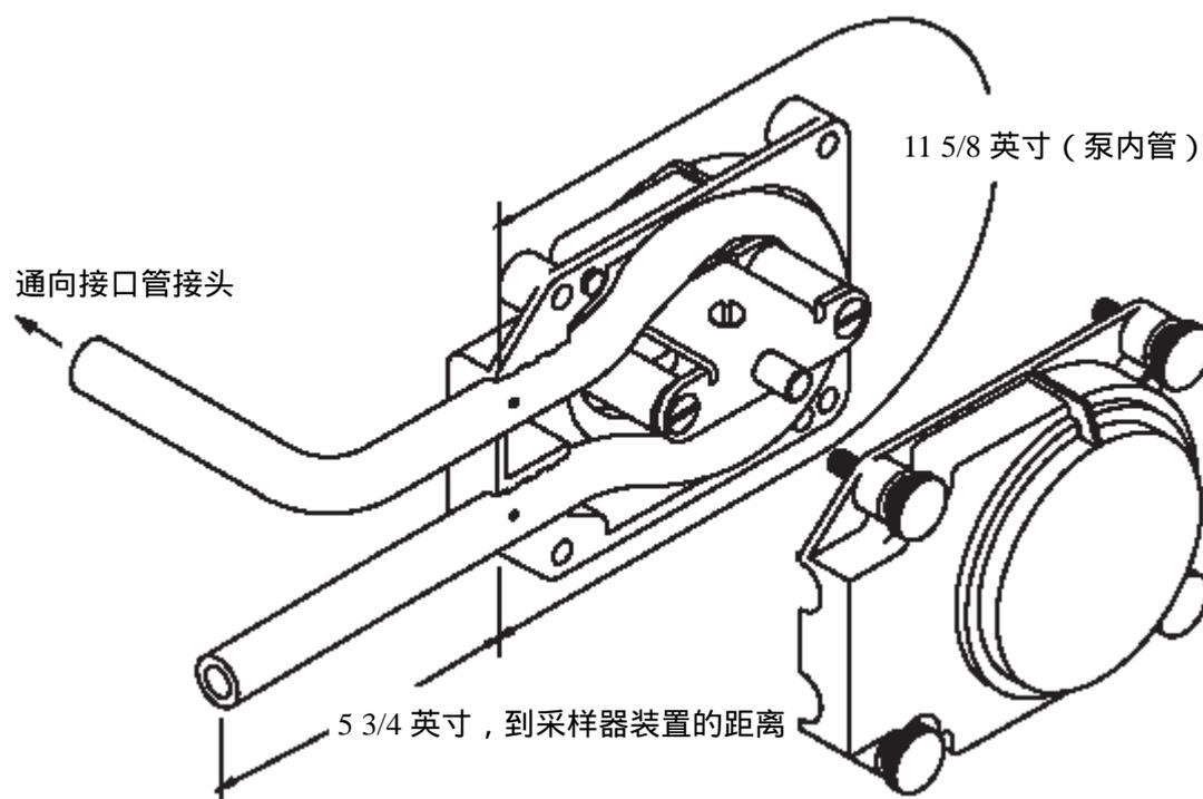
**图 7 安装泵管通过传感器体**
