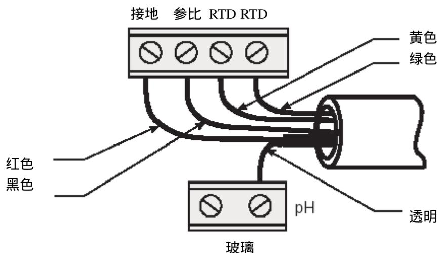
图 24 pH 值探头与接线盒的连接（未接地）
