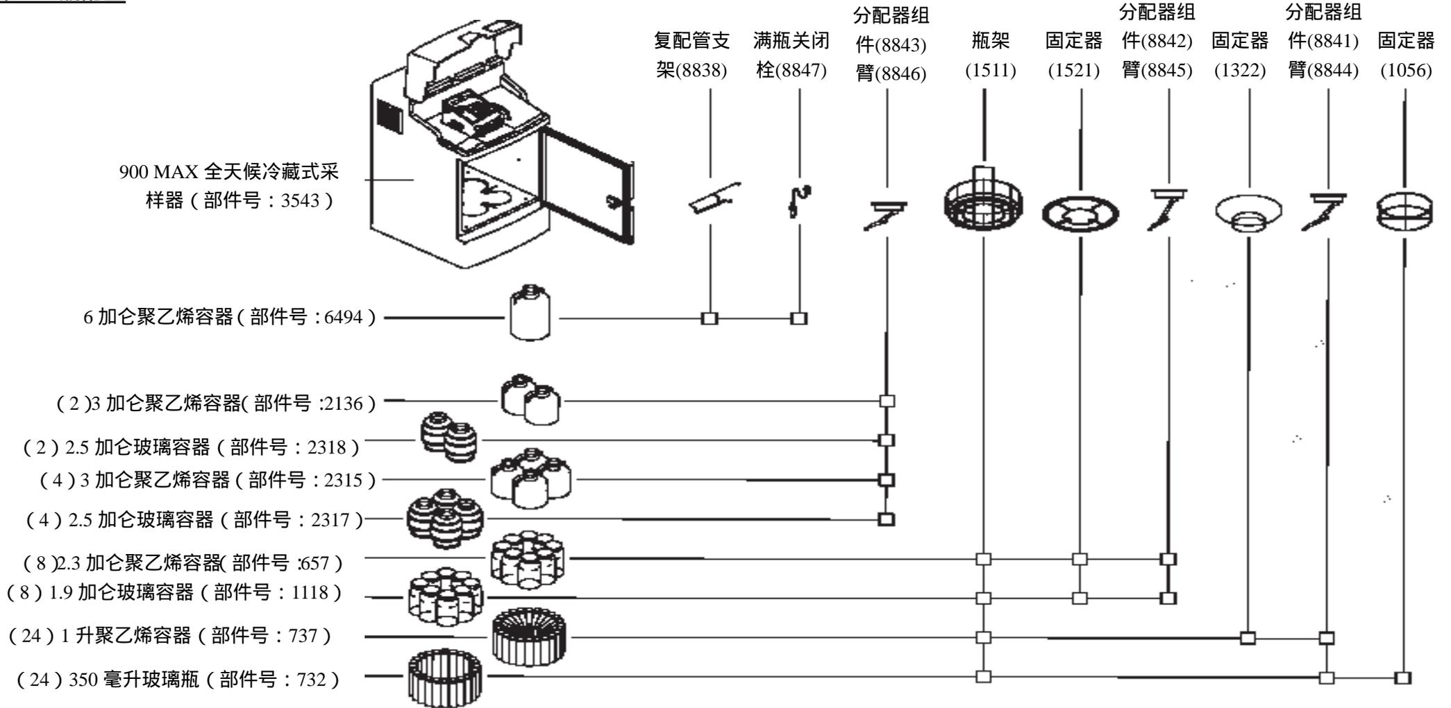
对于四瓶采样，安装分配器，将所有四瓶都放在瓶架上，如图 12 所示。
