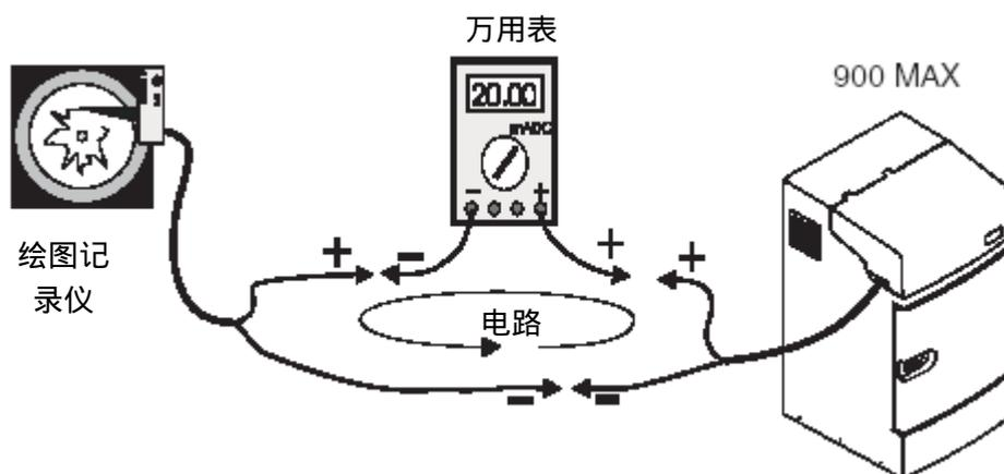
图 28 将 4~20 mA 装置从电路中脱开进行校准
