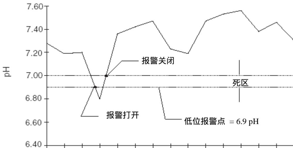
在 pH 值的示例 (图 31) 中, 死区被设置为 0.10 pH。当 pH 值达到 6.9 (下面一条虚线) 时, 报警触发, 但是报警并不会关闭, 直到 pH 值回到 7.00 为止。这种差值就是死区设定, 它应当是根据所测定项的特征来进行设置的。
