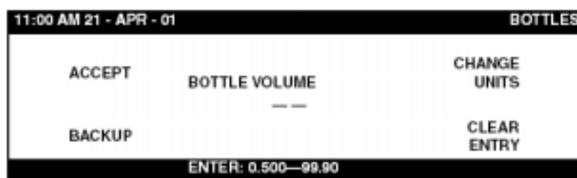
1-D .按“ACCEPT(接受)”软键继续,转入“Intake Tube (进口管)”菜单。
