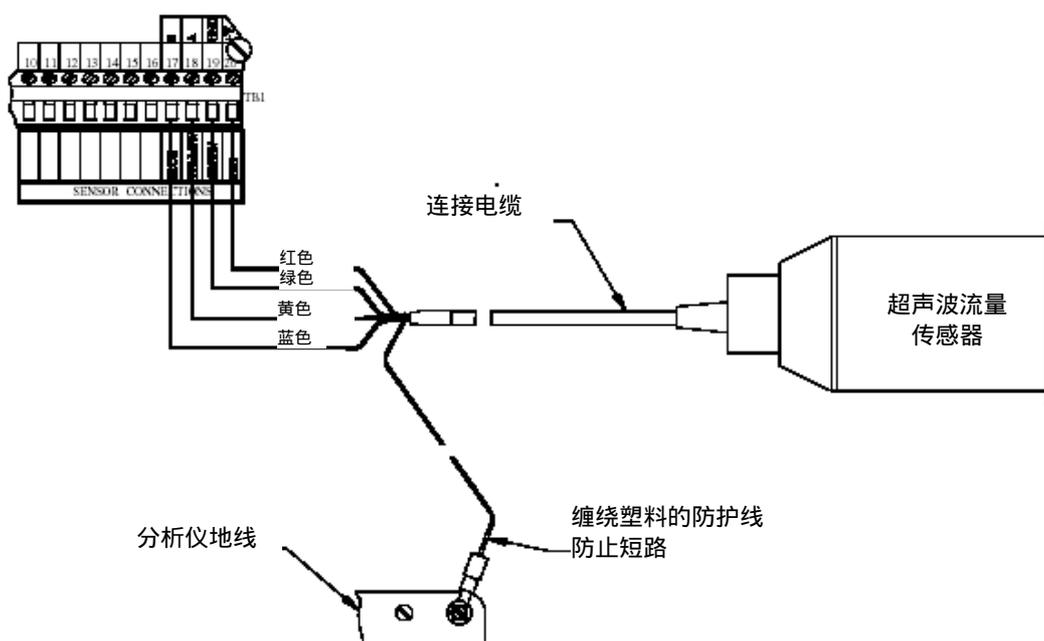
图2-5 超声波流量传感器的连接
