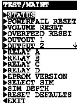
1. 随着屏幕显示 **SELECT SIM** ，使用↓键选择“SIM SENSOR”（SIM 传感器）文本行。
