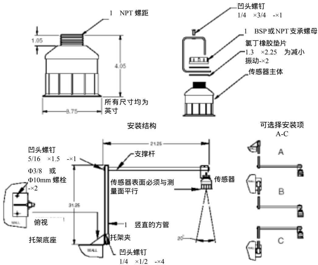
图2-1 超声波流量计传感器安装尺寸详图
