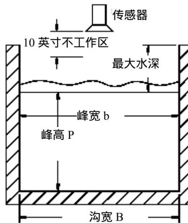
图3-5 矩形堰（底部不收缩）尺寸设计
