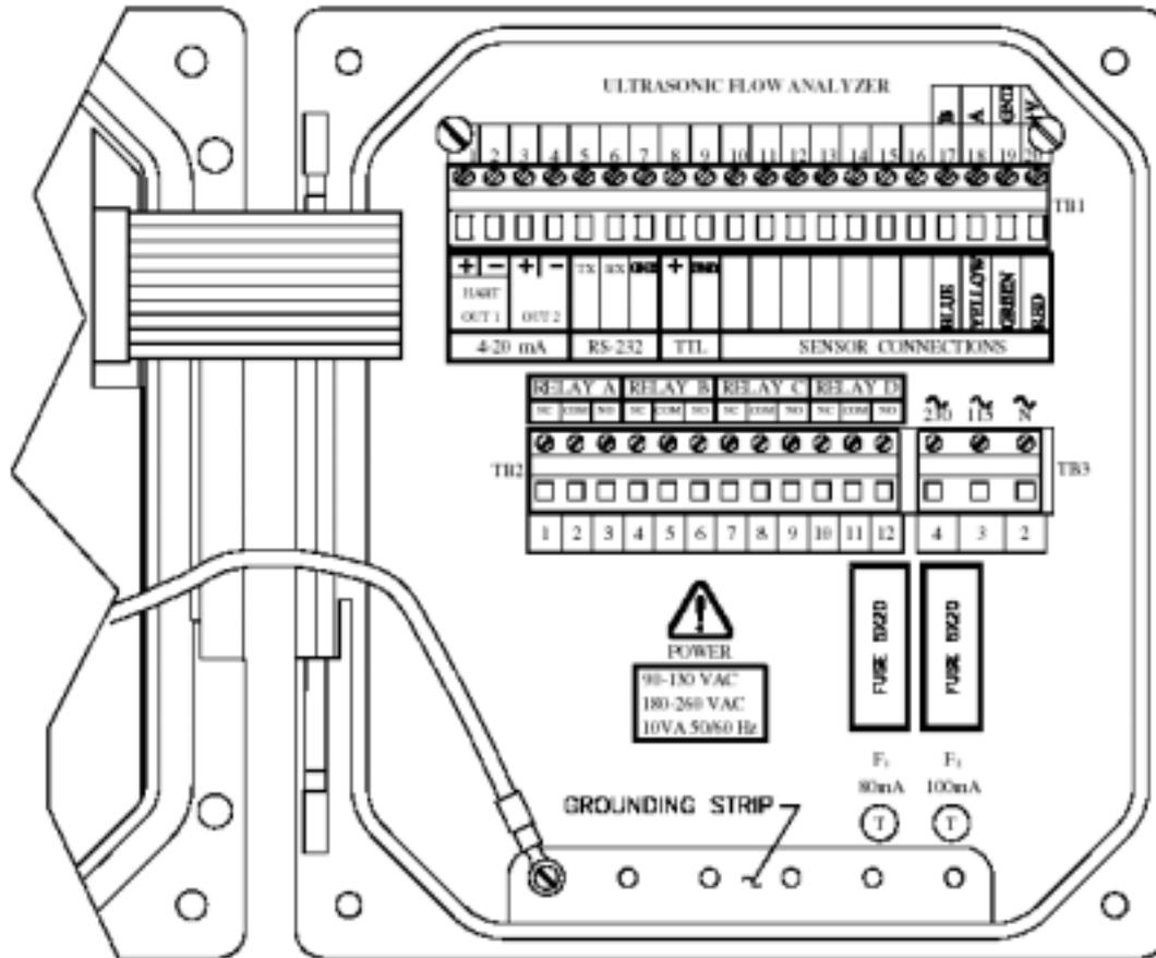
图 2-4 分析仪接线端子指示
