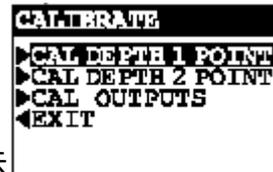
3. 用↓键选择“CAL DEPTH 2 POINT”(2点水深校准法)文本行,按 ENTER (确认)键,显示
