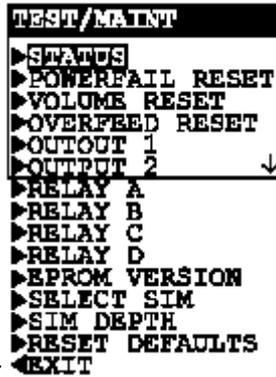
1. 随着屏幕显示 **◀EXIT**，用 **↓** 键选择 “ OVERFEED RESET ” ( 过量重新设置 ) 文本行。
