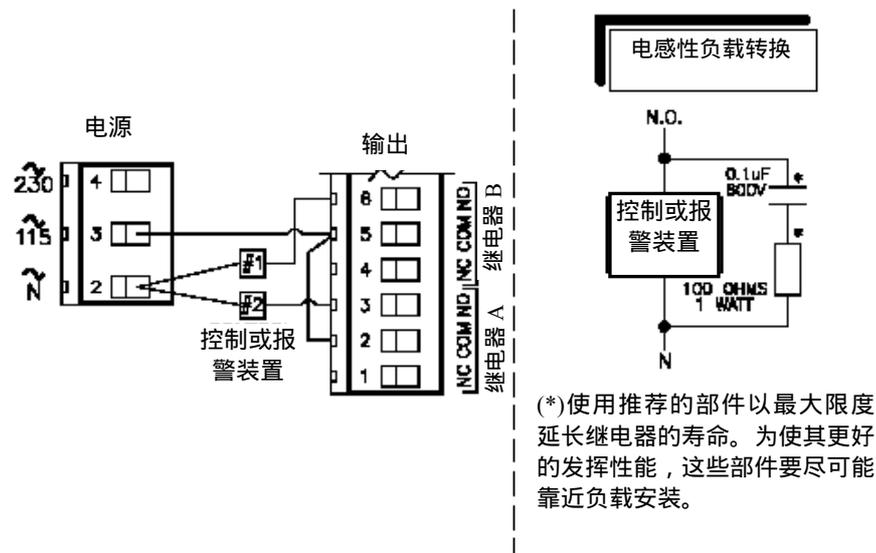
图 2-6 连接控制/报警装置与继电器
