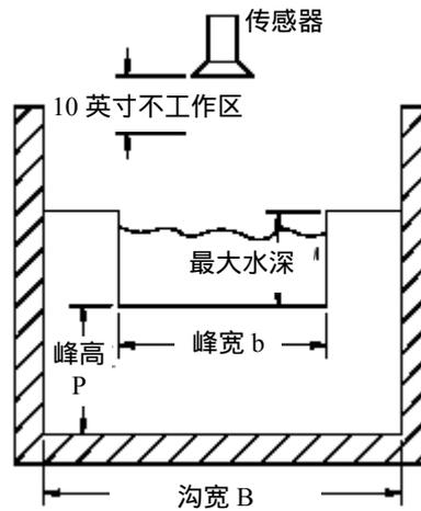
图3-4 矩形堰（底部收缩）尺寸设计
