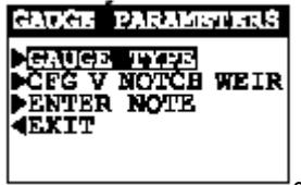
2. 当选择“GAUGE TYPE”（测试类型）时，按 ENTER（确认）键显示
