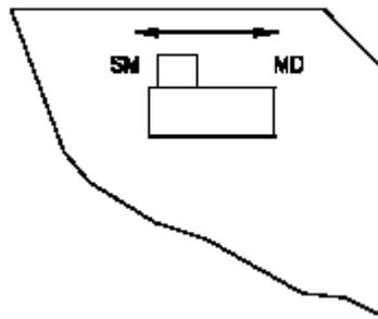
图3-6 单分析仪模式/多分析仪模式开关位置 (仅用于装备有 HART 的分析仪)
